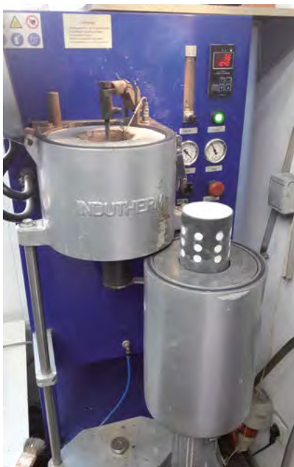
Bild 7: Schmelz- und Gießofen mit Gießform (Foto: Albert Sturm)
