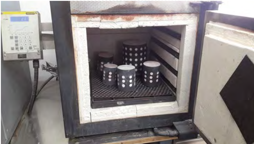
Bild 6: Trocknung und Ausschmelzen der Form im Ofen (Foto: Albert Sturm)
