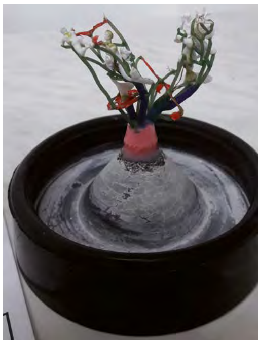
Bild 4: Komplette Gießstrauben (Foto: Albert Sturm)
