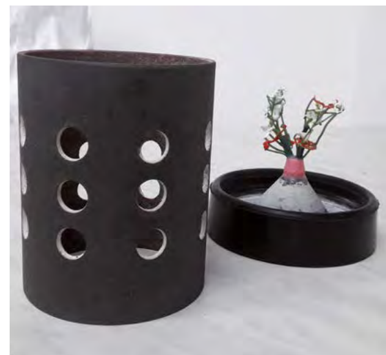
Bild 5: Vorbereitung der Formherstellung (Foto: Albert Sturm)
